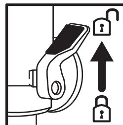
**Nota:** Per bloccare la fresa a una particolare profondità di taglio, immergere la testa della fresatrice e ruotare la Leva di blocco immersione (18) nella sua posizione di blocco più bassa. Ciò terrà la testa della fresa ferma in posizione.
