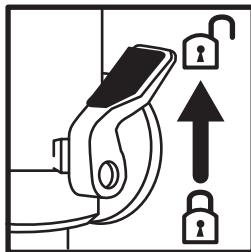
**Remarque :** pour verrouiller la défonceuse sur un réglage de profondeur particulier, abaissez la tête de la défonceuse puis pivotez le levier de verrouillage de la profondeur (18) sur sa position la plus basse. Cela permettra de maintenir la position de la tête de la défonceuse.
