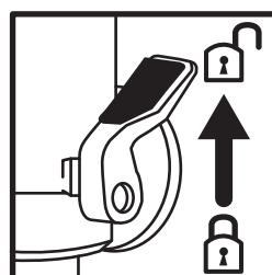
**Hinweis:** Senken Sie den Fräser zum Arretieren in der benötigten Frästiefe ab und drehen Sie den Spannhebel zur Frästiefenarretierung (18) in die niedrigere Position. Dadurch wird der Fräskopf in dieser Stellung fixiert.
