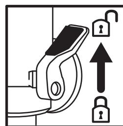
**Poznámka:** Abyste uzamkli horní frézku v určité hloubce frézování, zatlačte na horní frézku směrem dolů a otočte zajišťovací páčku hloubky frézování (18) do nižší pozice. Tím horní frézku udržíte v určené hloubce
