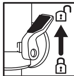
**Nota:** Para ajustar la fresaadora a una profundidad de corte requerida, sujeté el cabezal de la fresaadora hacia abajo y gire la palanca de bloqueo de profundidad (18) hasta su posición más baja. Esto mantendrá el cabezal de la fresaadora en esta posición requerida.
