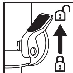
**Opmerking:** Om de bovenfrees op een bepaalde diepte te vergrendelen, duwt u de kop naar beneden en draait u de inval vergrendelhendel (18) in de lagere positie. Dit houdt de freeskop in deze positie.
