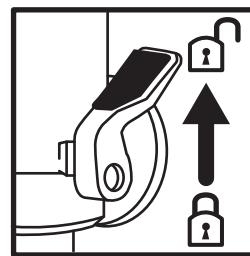
**Nota:** Para travar a tupia em uma determinada profundidade de corte, empurre a cabeça da tupia para baixo e gire a Alavanca da trava de imersão (18) até sua posição mais baixa. Isto manterá a cabeça da tupia em sua posição.
