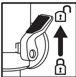
**Nota:** Para ajustar la fresadora a una profundidad de corte requerida, sujeté el cabezal de la fresadora hacia abajo y gire la palanca de bloqueo de profundidad (18) hasta su posición más baja. Esto mantendrá el cabezal de la fresadora en esta posición requerida.
